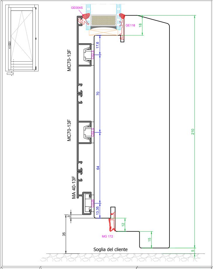
FINESTRA 68\*70 TEL, 68\*77 ANTA SEZIONE NODO INFERIORE PORTAFINESTRA
