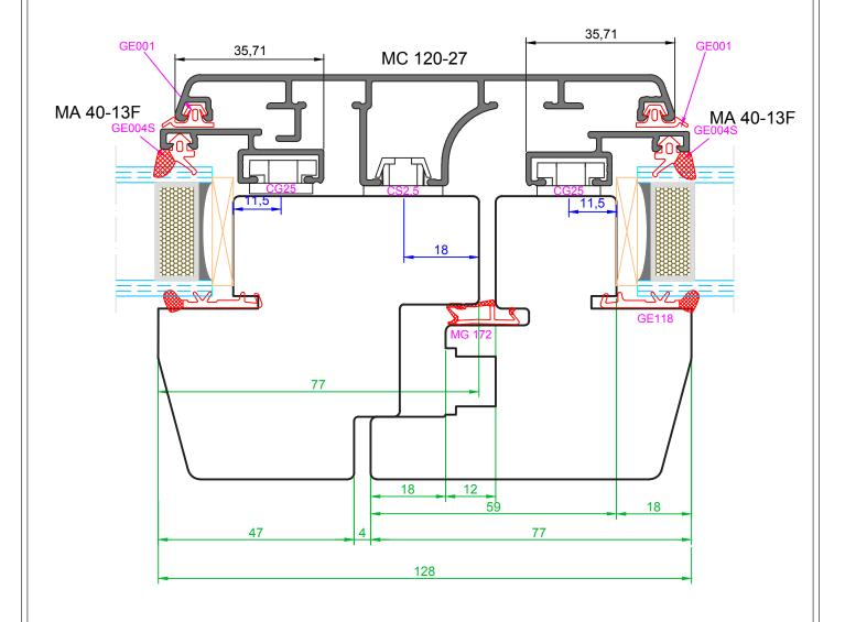
FINESTRA 68\*70 TEL, 68\*77 ANTA SEZIONE NODO CENTRALE SENZA MONTANTINO
